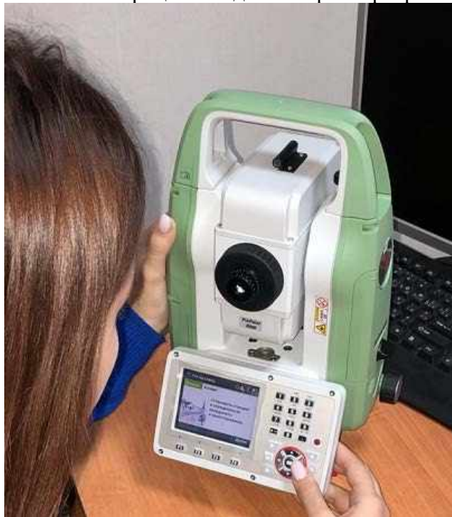
Рисунок 7 Работа электронным тахеометром
